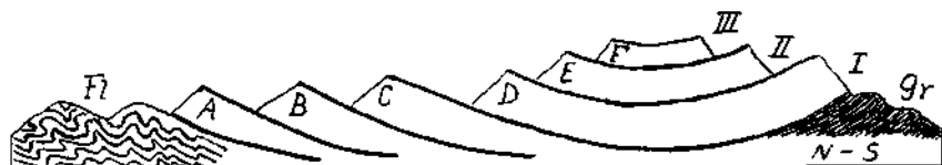
Fig. 10. Querschnittsschema der Schubmassen der nördlichen Kalkalpen. Gr = Grauwackenzone. Fl = Flyschzone. A-B-C-D-E-F = Rangstufen der Schubmassen, gerechnet von der Flyschbasis. I-II-III = Rangstufen der Schubmassen, gerechnet von der Grauwackenbasis. A-B-C sind nur Absplüßungen von D.
